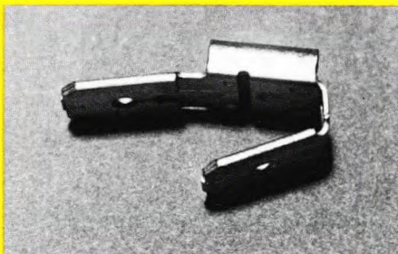
Afb. 19. Op punt 1 van de print komen 2 kabels met stekerverbinding. Hiertoe moet een tweelingsteker worden aangebracht die er zo uitziet.
